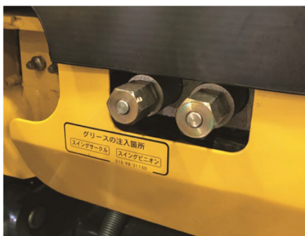
図6 アタッチメント用油圧取り出し口 (カタログより引用)
