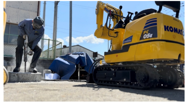
図7 アタッチメント用油圧取り出し口使用例：ブレイカー
