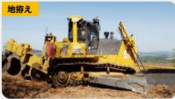
地拵え 地拵え用機械 D85EX サブソイラー
