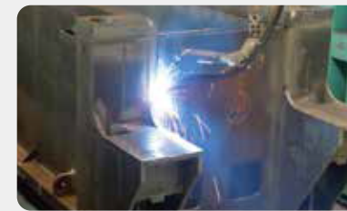
タンデム溶接ロボット（大型プレス用） Tandem welding robot (for large presses)
