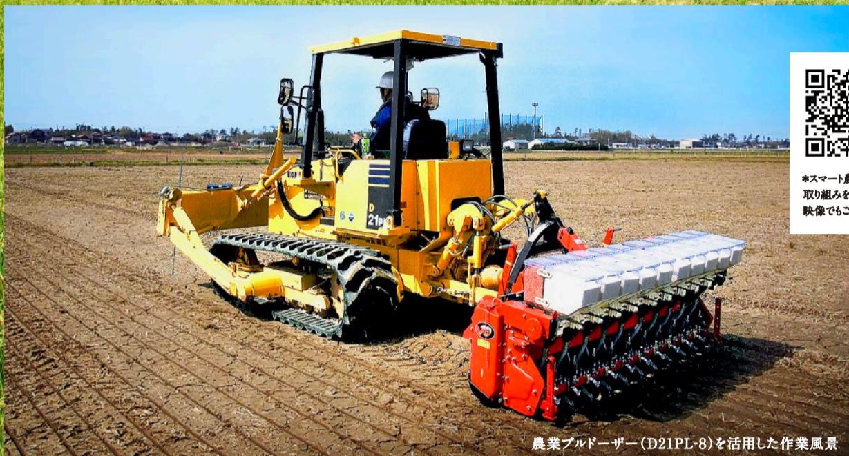
農業ブルドーザー(D21PL-8)を活用した作業風景
