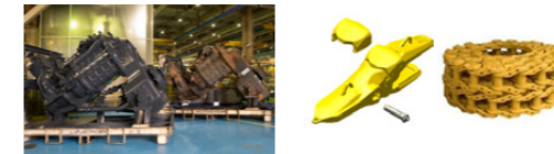
エンジンなどのリマン(コンポーネント再生)
