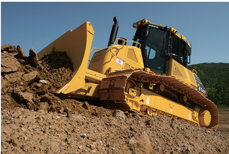
2013年6月から市場導入したICTブルドーザーD61PXi-23
