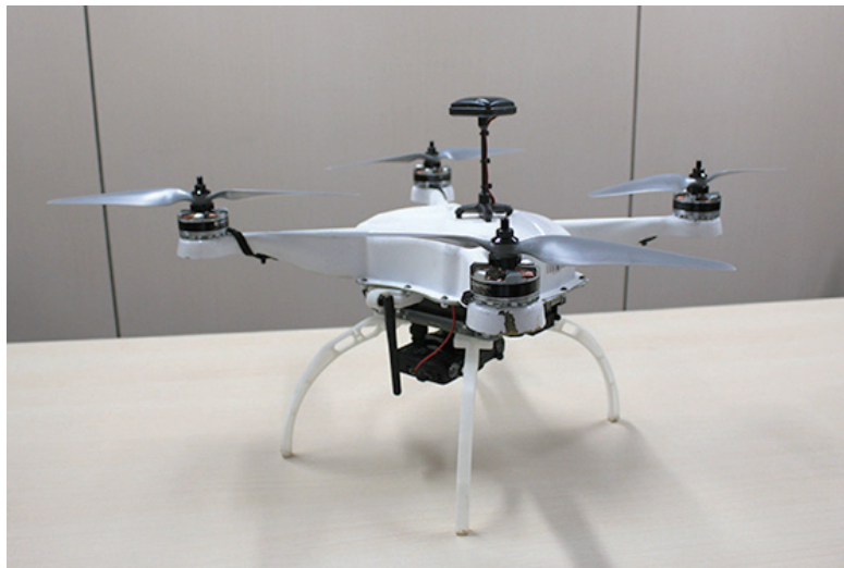
現地測量に使用するSkycatch社製ドローン
