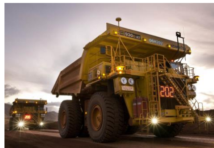
無人ダンプトラック/鉱山プラットフォーム
