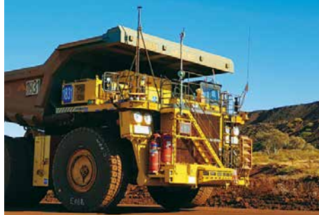
AHS改造後付キットを搭載し無人稼働する「830E」(豪州リオ ティント社鉄鉱山)
