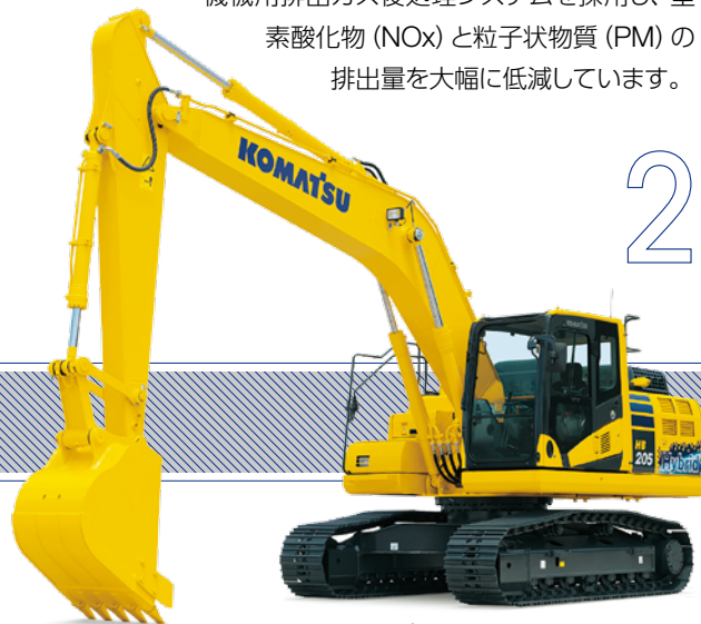
中型ハイブリッド油圧ショベル「HB205-3」 (一部オプションが含まれています)
