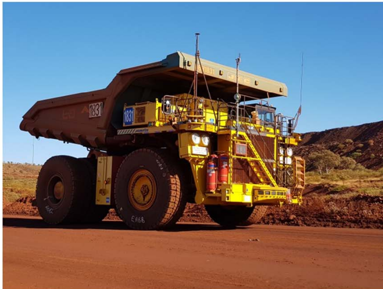
AHS改造後付キットを搭載し 無人稼働する830E (場所：豪州リオ ティント社鉄鉱山)
