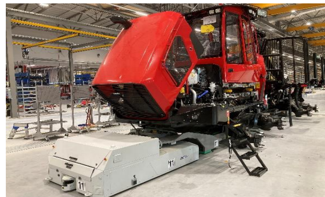
AGV（Automated Guided Vehicle） を活用した自動牽引組み立てライン
