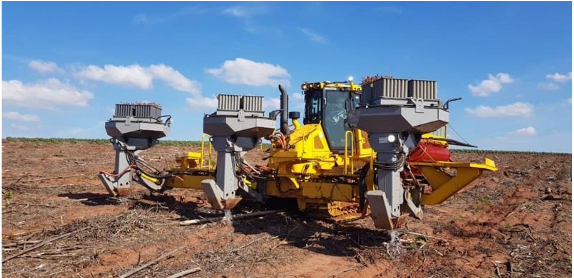
ブラッケ社アタッチメントを取り付けたコマツ製ブルドーザー
