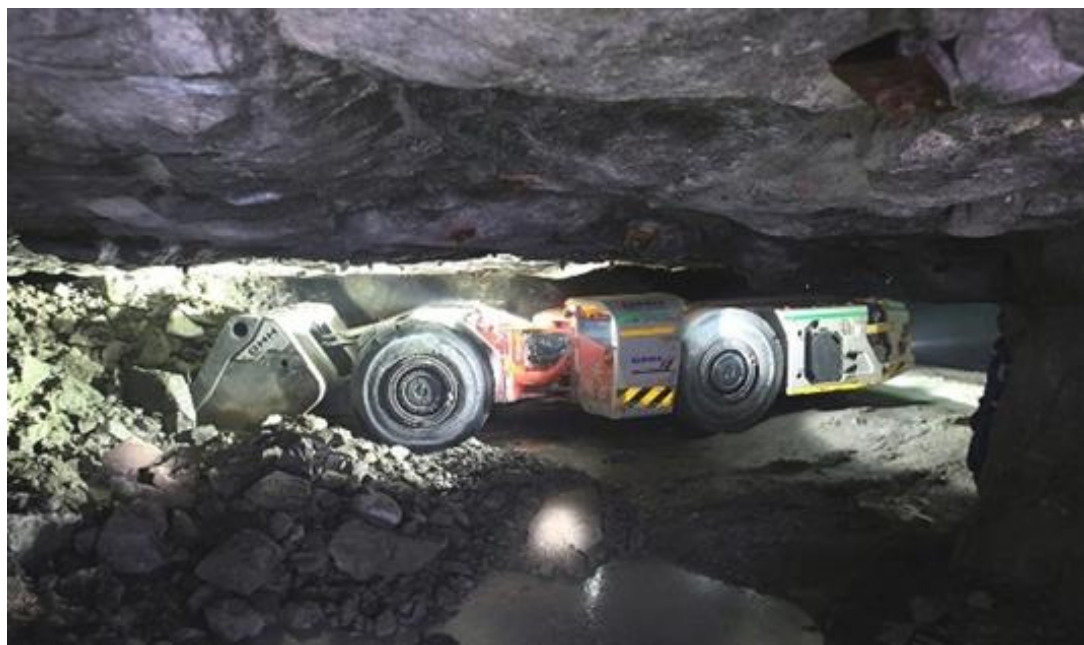
狭い坑道に適したGHH社のLHD（ロードホールダンプ）
