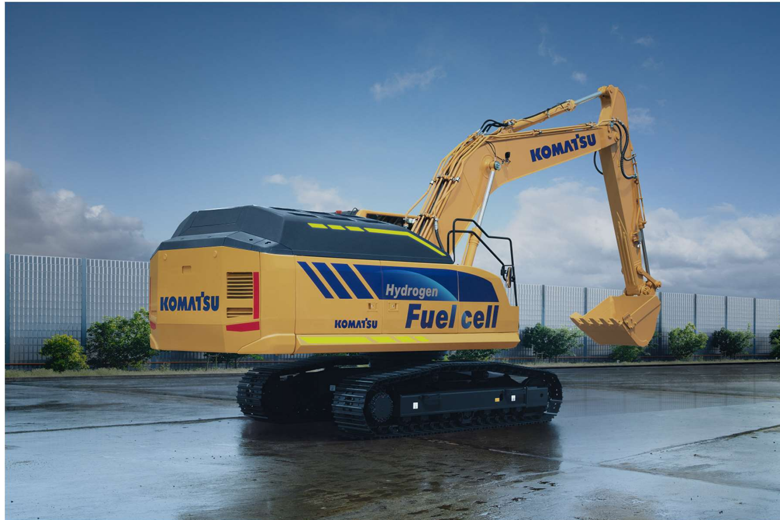
水素燃料電池を搭載した中型油圧ショベルのコンセプトマシン
