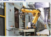
重要部品の1/1000mm単位の精密加工、高 強度化のための熱処理など自動高能率加工 ラインで生産。加工における重要工程の全数
