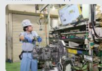
セル生産\*により、生産量の変動に柔軟 に対応。トルク数を全数自動管理。 \*セル生産…小スペースで製品を1台づつ組み立てる。
