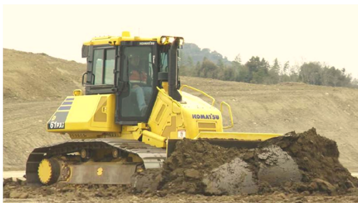
世界初*の全自動ブレード制御機能を搭載した中型ICTブルドーザー「D61PXi-23」
